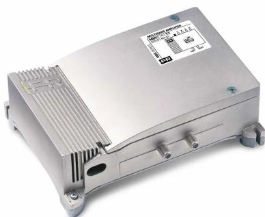
**Unidad central autoamplificada para interior de 4 entradas (III+DAB, IV, V, UHF)** con ganancia de 43dB y nivel de salida hasta **125dB $\mu$ V en la banda UHF**, amplificación de banda separada, ajustes de ganancia independientes (0-20dB) para cada entrada y baja figura de ruido. **Tecnología T2** con filtro integrado para eliminar interferencias 5G a 694MHz.
