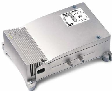
Station pour intérieur auto-alimentée à 4 entrées (III+DAB, IV, V, UHF) avec un gain de 43dB et un niveau de sortie jusqu'à 125dB $\mu$ V dans la bande UHF, amplification séparée des bandes, réglage du gain indépendant (0-20dB) pour chaque entrée et faible facteur de bruit. **Technologie T2** avec filtre intégré pour éliminer les interférences 5G à 694MHz.
