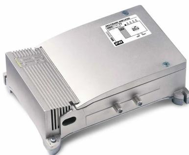
**Unidad central autoamplificada para interior de 4 entradas (III+DAB, IV, V, UHF)** con ganancia de 31dB y nivel de salida hasta **125dB $\mu$ V en la banda UHF**, amplificación de banda separada, ajustes de ganancia independientes (0-20dB) para cada entrada y baja figura de ruido. **Tecnología T2** con filtro integrado para eliminar interferencias 5G a 694MHz.
