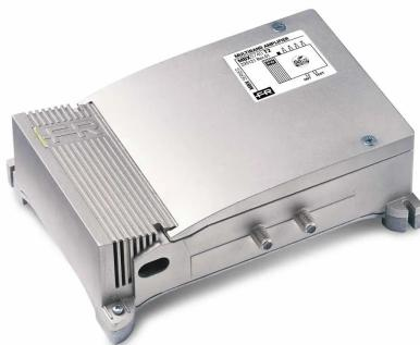
Station pour intérieur auto-alimentée à 4 entrées (FM, III+DAB, UHF) avec un gain de 43dB et un niveau de sortie jusqu'à 125dB $\mu$ V dans la bande UHF, amplification séparée des bandes, réglage du gain indépendant (0-20dB) pour chaque entrée et faible facteur de bruit. Technologie T2 avec filtre intégré pour éliminer les interférences 5G à 694MHz.
