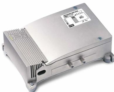
Centrale con 1 ingresso (III+DAB+UHF) autoalimentata da interno con guadagno 43dB e livello di uscita fino a 125dB $\mu$ V in banda UHF, amplificazioni a bande separate, regolazioni del guadagno (0-20dB) indipendenti per ogni banda e bassa figura di rumore. **Tecnologia T2** con filtro integrato per eliminare le interferenze 5G a 694MHz.
