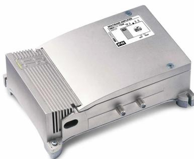
Unidad central autoamplificada para interiores con 4 entradas (FM, III+DAB, UHF, UHF) con una ganancia de 43 dB y un nivel de salida de hasta 125 dB $\mu$ V en la banda UHF, amplificación de banda independiente, ajustes de ganancia independientes (0-20 dB) para cada entrada y baja figura de ruido. Filtro 5G y 4G LTE de 694 MHz integrado y enchufe británico tipo G.
