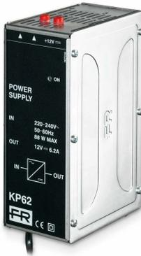
Realizzati con tecnologia switching per assicurare alto rendimento e affidabilità, protetti da sovraccarichi sia temporanei che prolungati. Classe d'isolamento: II. Temperatura di funzionamento da -10°C a +55°C.
