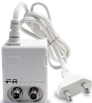
Fuente de alimentación conmutada estabilizada en miniatura de 24 V, de alta eficiencia y bajo consumo, con 1 entrada, 1 salida y una corriente de salida de 130 mA. Conector tipo C para conexión a la red eléctrica.
