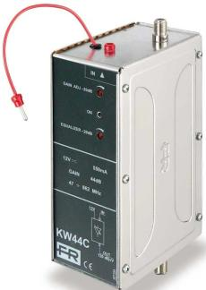
Amplificateurs finaux haut débit avec technologie push-pull qui permettent d'amplifier toute la bande 47-862 MHz. Equipés d'une entrée et d'une sortie, ils permettent d'amplifier le signal provenant d'une batterie de filtres KF ou d'autres modules (récepteurs, modulateurs, etc. ).
