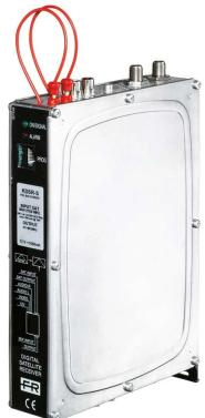
Gamma di ricevitori digitali QPSK per la ricezione di programmi in chiaro trasmessi da satellite.
