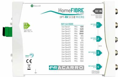
El receptor OPT-RX SCD MICRO convierte la señal de entrada óptica en una señal coaxial disponible en dos salidas dCSS (SCD2) y dos salidas Legacy, todas con la señal de TV mezclada. El receptor puede alimentarse directamente desde decodificadores o mediante un conector de CC dedicado. El producto está equipado con un LED verde multifunción que proporciona al instalador información diversa:
