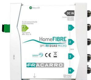
El receptor **OPT RX QD MICRO** convierte la señal óptica de entrada en una señal coaxial disponible en 4 tomas mixtas TV-SAT. El receptor puede alimentarse directamente desde los decodificadores conectados a las salidas o desde el conector de CC dedicado. El producto está equipado con un LED verde multifunción que proporciona al instalador información diversa:
