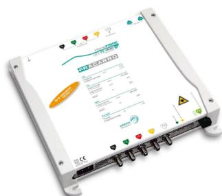
Émetteur optique qui permet de distribuer jusqu'à 4 satellites sur une seule fibre en utilisant la technologie CWDM (Coarse Wavelength Division Multiplexing). Solution innovante qui permet de transmettre toute la bande TV, la FM, et une position orbitale sur une seule fibre. Puissance de sortie 7 dBm SAT + TV + FM, longueur d'onde 1530 nm. (dimensions 230x230x50mm)
