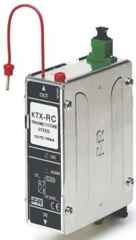
L'émetteur optique KTX-RC convertit la voie de retour optique à longueur d'onde 1310nm. Bande d'entrée 5-65MHz.
