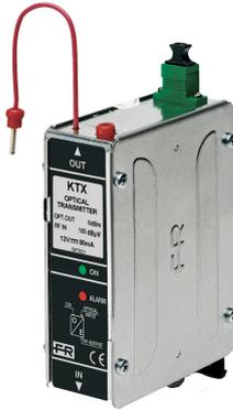
L'émetteur optique KTX convertit le signal RF TV SAT en signal optique à longueur d'onde 1310nm. Bande d'entrée 47-2150MHz.
