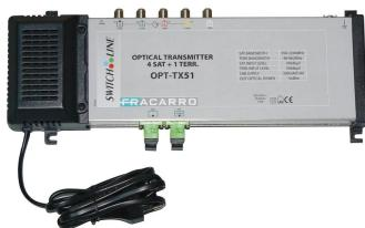
El emisor OPT-TX51 convierte y distribuye las 4 polaridades satelitales y la señal digital terrestre con un solo cable de fibra, lo que permite ahorrar costes y tiempo de instalación. El emisor está equipado con una entrada óptica adicional que puede utilizarse para la transmisión de un canal auxiliar en un rango óptico comprendido entre 1260 nm y 1500 nm.
