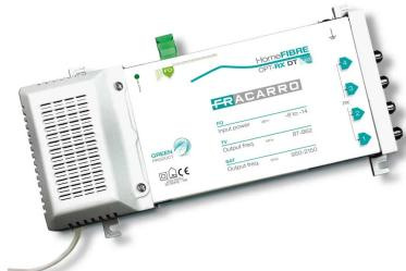
Le récepteur OPT-RX DT convertit le signal optique entrant en 4 sorties universelles, mettant ainsi le signal TV et SAT avec tous les services et contenus offerts par les diffuseurs à la disposition de 4 utilisateurs différents, comme s'ils étaient directement connectés à leur propre antenne et parabole. Le produit est équipé d'une alimentation électrique et doit donc être branché sur le secteur via son câble d'alimentation
