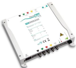
Emisor óptico para la distribución de hasta 4 satélites en una sola fibra con tecnología CWDM (Multiplexación por División de Longitud de Onda Gruesa). Solución innovadora que permite la transmisión de toda la banda de TV, incluyendo señales de radio, y una posición orbital completa en una sola fibra. 7 dBm con láser FP SAT+TV+FM, longitud de onda de 1310 nm. (Dimensiones: 230 x 230 x 50 mm)
