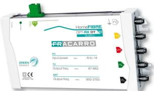
Le récepteur OPT-RX DT QUATTRO convertit le signal optique entrant en 4 sorties SAT indépendantes VL, HL, VH, HH et 1 TV pour les installations multiswitch. Le produit est télécommandable via les sorties SAT.
