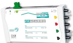
Il ricevitore OPT-RX DT QUATTRO converte il segnale ottico in ingresso in 4 uscite indipendenti SAT VL, HL, VH , HH e 1 TV per impianti a multiswitch. Il prodotto è telealimentabile tramite le uscite SAT.
