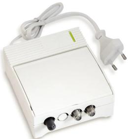
Récepteur optique autoalimenté TV+FM, connecteur optique FC/PC, jarretière optique incluse. Dimensions 120x97x43mm.
