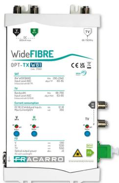
L'innovativa soluzione **Wide Fibre Fracarro** è stata progettata per garantire una facile installazione dalla testata fino alla presa a muro. Il trasmettitore riesce a gestire i segnali RF provenienti da un sistema parabolico dotato di un **LNB wideband (V, H)** e da un **antenna Digitale terrestre**.
