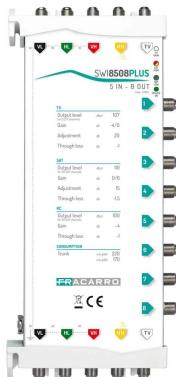
Multiswitch **en cascada** de 5 entradas y 8 salidas derivadas con **ganancia activa** y ajuste separado en las bandas de TV y Satélite (banda alta y baja con ajustes separados).
