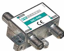
**Insertador de tensión con protección de tonos DiSEqC generados por el receptor o decodificador y corriente máxima de paso de 450 mA, suficiente para alimentar un puerto SCR (190 mA típico) o un puerto SCD2 dCSS (350 mA típico).**
