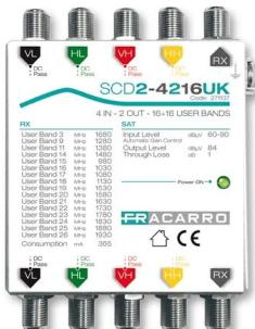
Multiswitch cascadable SCD2 (dCSS), 4 entrées avec CAG et 2 ou 4 dérivées de 16 fréquences chacune, entièrement alimentées par décodeur.
