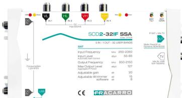
**Cabecera compacta FI-FI** para la conversión de hasta 32 transpondedores DVB-S/S2 con tecnología SCD2 (dCSS); **4 entradas de satélite, 1 entrada de TV pasiva y 1 derivada mixta** con un nivel total de salida de satélite de 127 dBuV; **ajuste de ganancia de satélite de 20 dB y ajuste de pendiente de satélite de 15 dB.**
