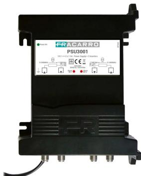
Fuente de alimentación de 18V y 3A con 2 insertadores DC balanceados (máximo 1,5 A cada uno) en conector F hembra y enchufe UK.
