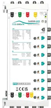
Multiswitch en cascada SCD2 (dCSS), 5 entradas activas y ajustables con CAG, también compatible con LNB de banda ancha y 8 salidas derivadas con 16 frecuencias cada una y **autodetección del modo de funcionamiento**. Alimentación completa mediante conector DC-IN, línea VL o decodificador. Frecuencias SKY Italia y SKY UK.
