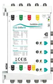
Multiswitch en cascada SCD2 (dCSS), 5 entradas activas y ajustables con CAG, también compatible con LNB de banda ancha y 4 salidas derivadas con 16 frecuencias cada una y **autodetección del modo de funcionamiento**. Alimentado completamente por conector DC-IN, línea VL o decodificador. Frecuencias SKY Italia y SKY UK.
