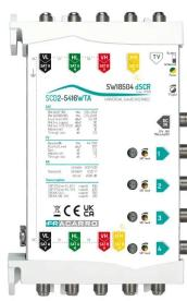
Multiswitch **cascadable SCD2 (dCSS)**, 5 entrées actives et réglables avec CAG également compatible avec **LNB Wideband** et **4 sorties** utilisateurs ayant 16 fréquences chacune et **autodétection du mode de fonctionnement**, alimenté entièrement par le **connecteur DC-IN, ligne VL** ou décodeur. Fréquences SKY Italia ed SKY UK.
