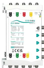
Multiswitch en cascada SCD2 (dCSS), 5 entradas con CAG, también compatible con LNB de banda ancha y 4 salidas derivadas con 16 frecuencias cada una y **autodetección del modo de funcionamiento**. Alimentado completamente por conector DC-IN, línea VL o decodificador. Frecuencias SKY Italia y SKY UK.
