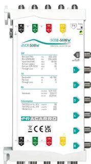
Multiswitch en cascada SCD2 (dCSS), 5 entradas con CAG, también compatible con LNB de banda ancha y 6 salidas derivadas con 16 frecuencias cada una y **autodetección del modo de funcionamiento**. Alimentación completa mediante conector DC-IN, línea VL o decodificador. Frecuencias SKY Italia y SKY UK.
