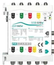
Multiswitch en cascada SCD2 (dCSS), 5 entradas con CAG, también compatible con LNB de banda ancha y 2 salidas derivadas con 16 frecuencias cada una y **autodetección del modo de funcionamiento**. Alimentación completa mediante conector DC-IN, línea VL o decodificador. Frecuencias SKY Italia y SKY UK.
