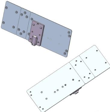
Soporte modular para carril DIN de 26,5 cm para instalar productos dentro de QDSAs o sobre carriles DIN dentro de racks.
