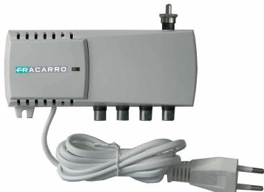
Modulateurs audio-vidéo analogiques à double bande latérale avec réglage du canal de sortie via dip-switch ou afficheur intégré. La stabilité de la fréquence est garantie par la synthèse PLL gérée par un microprocesseur. Les modulateurs peuvent être alimentés à distance par le récepteur ou localement par une alimentation externe.
