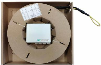
**Boîte de terminaison optique plate en plastique**, préconnectée des **deux côtés**, avec 4 prises SC/APC et tireur ; disponible avec **11-19 m** de câble à 4 fibres pour les installations multiservices **FTTH**; solution très utile pour amener tous les services centralisés dans le CSOE des installations FTTH à l'intérieur de chaque unité d'habitation individuelle.
