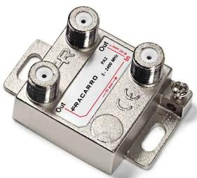
Derivador vertical unidireccional con atenuación de 10dB y conector F en bandas de TV y Satélite (5-2400MHz).
