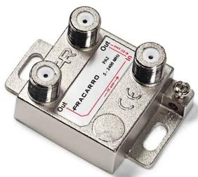
Derivador vertical unidireccional con atenuación de 14dB y conector F en bandas de TV y Satélite (5-2400MHz).
