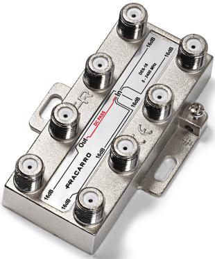
Derivador vertical de 6 vías con atenuación de 16dB y conector F en banda de TV y Satélite (**5-2400MHz**).
