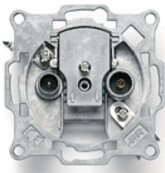
**Base de empotrar redonda** con atenuación de 6dB; **2 salidas demezcladas** con conector IEC hembra para la banda de TV (5-40MHz, 47-862MHz) y conector IEC macho para la banda de Satélite (950-2300MHz).
