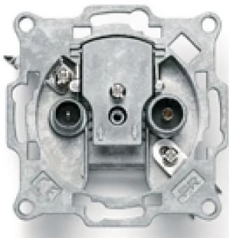
Prise dérivée ronde encastrable avec atténuation de 10dB ; 2 sorties avec connecteur IEC femelle pour la bande TV (5-40MHz, 47-862MHz) et connecteur IEC mâle pour la bande Satellite (950-2300MHz).
