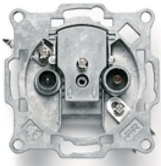
Prise dérivée ronde encastrable avec atténuation de 14dB ; 2 sorties avec connecteur IEC femelle pour la bande TV (5-40MHz, 47-862MHz) et connecteur IEC mâle pour la bande Satellite (950-2300MHz).
