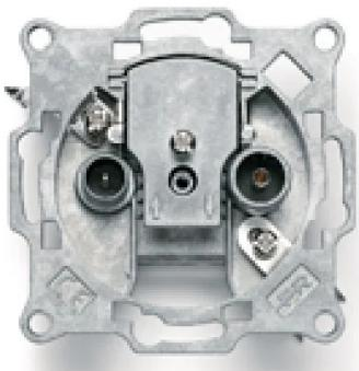
Prise dérivée ronde encastrable avec atténuation de 18dB ; 2 sorties avec connecteur IEC femelle pour la bande TV (5-40MHz, 47-862MHz) et connecteur IEC mâle pour la bande Satellite (950-2300MHz).
