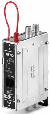
Convertisseur FI-FI DVB-S2 programmable qui permet la conversion d'un transpondeur satellite numérique de la bande 950 ÷ 2150 à n'importe quelle fréquence de la même bande. Il permet également la conversion isofréquence pour utiliser le convertisseur comme filtre.
