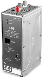
Récepteur numérique QPSK pour la réception de programmes en clair transmis par satellite. Équipé d'un modulateur à double bande latérale multistandard. Il permet également de recevoir des programmes SCPC. Mise à jour automatique des PID.
