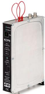
Processeur de canal programmable pour convertir un MUX numérique ou un canal analogique dans toute la bande RF (47-862 MHz) dans un autre canal dans la même bande. Paramètres d'entrée et de sortie entièrement programmables via le programmeur TPE.
