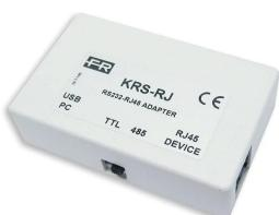
KRS-RJ (codice 282732) è un adattatore USB-RS485 con interfaccia USB-seriale necessaria per la programmazione delle centrali serie K, SAF, Digiflex e Headline tramite PC (da utilizzare in abbinamento con FHM).
