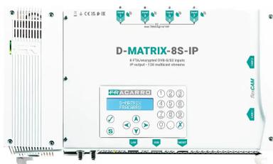
La centrale compatta **D-Matrix-8S-IP** permette di ricevere da **8 diversi transponders satellitari indipendenti** i programmi HD o SD desiderati (**FREE o codificati**) e di rimodularli in IPTV fino a 128 flussi multicast o unicast in uscita.
