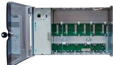
Le coffret 3DG-BOX est équipé de **6 emplacements** pour installer, alimenter et programmer les transmodulateurs de la famille 3DGFlex. Le coffret est équipée de tous les accessoires pour un montage **mural, au sol ou en rack standard de 19 "**.
