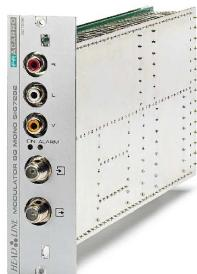
Modulateur à double conversion équipé d'un double filtre SAW filtre. Un seul module permet de couvrir toute la bande 47-862MHz, rapport C / N élevé dans la bande qui permet la distribution de plus de 80 canaux. Disponible en standard PAL B / G mono (SIG7282), PAL B / G stéréo (SIG7282S) et multistandard (SIG7281).
